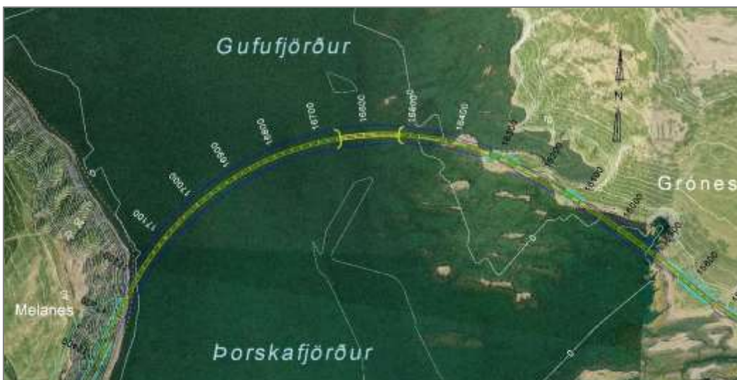
Mynd 4.2.11. Möguleg þverun Gufufjarðar, Grónes-Melanes. 2 m hæðarlínur (loftmynd: Loftmyndir ehf.).
